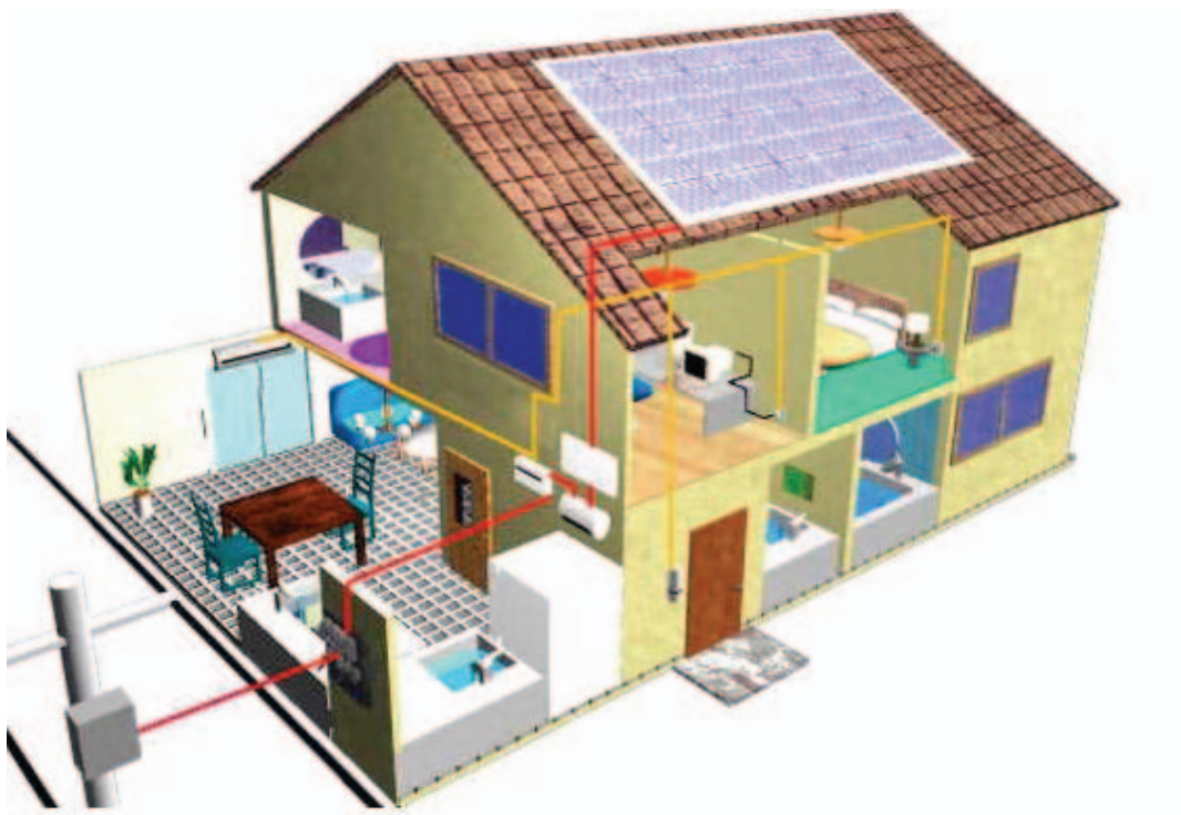
Figura 2. Esquema de uma casa com instalação fotovoltaica conectada à rede elétrica de baixa tensão: com painéis, medição e equipamentos de consumo.
